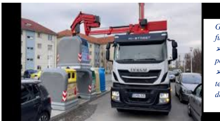
Fig. 8. Autovehicule de colectare a deșeurilor prevăzute cu un sistem combinat de prindere pentru mai multe tipuri de pubele
